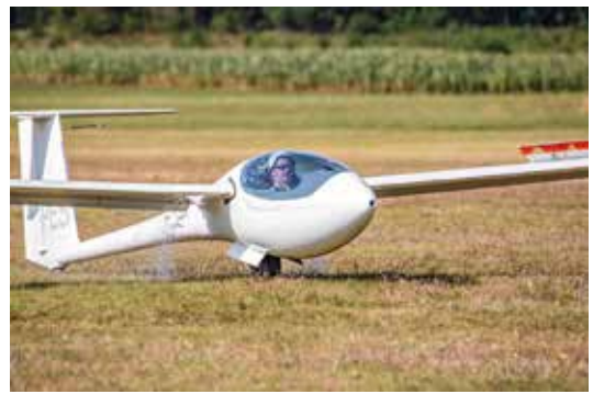
ASG 29E – prywatny. Jednomiejscowy szybowiec zawodniczy klasy osiemnastometrowej. Foto: redakcja
