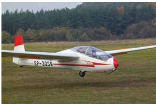
SZD 9 bis Bocian – Aeroklub Nadwiślański. Dwumiejscowy szybowiec, służący do szkolenia podstawowego. Foto: Waldemar Wingralek
