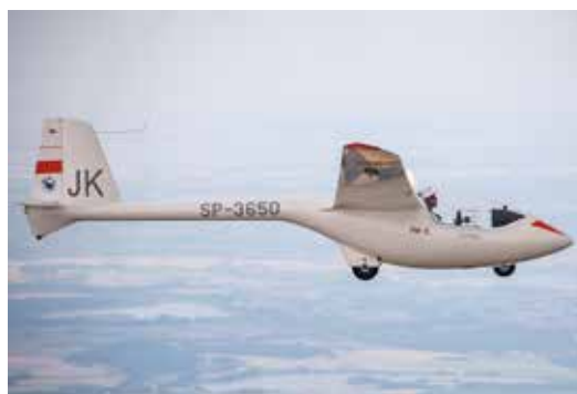
PW-5 Smyk – Aeroklub Nadwiślański. Jednomiejscowy szybowiec treningowy klasy światowej. Foto: Dominika Szagdał
