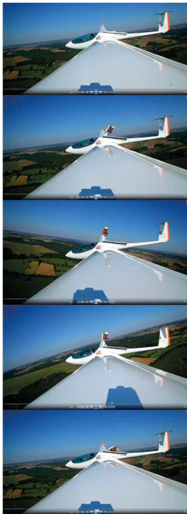
Karol Staryszak demonstruje wysuwanie, uruchamianie i chowanie silnika w locie w szybowcu ASG 29E. Foto: Karol Staryszak
